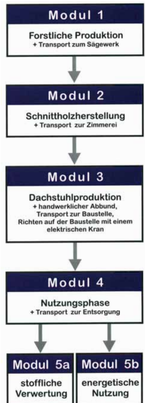
Bild 5.1 Der Lebensweg eines Dachstuhles
